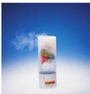
ภาพที่ 4.23 การหดตัวของลูกโป่งเมื่อแช่ในสารไนโตรเจนเหลวอุณหภูมิ -196^{\circ}\text{C}
