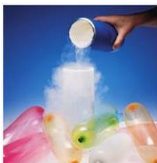
ภาพที่ 4.23 การหดตัวของลูกโป่งเมื่อแช่ในสารไนโตรเจนเหลวอุณหภูมิ -196^{\circ}\text{C}
