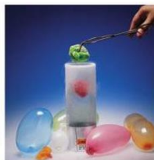
ภาพที่ 4.23 การหดตัวของลูกโป่งเมื่อแช่ในสารไนโตรเจนเหลวอุณหภูมิ -196^{\circ}\text{C}
